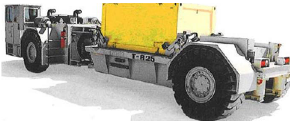
Abbildung 99: Beispielhafter Transportwagen für Horizontaltransport von Umverpackungen im Endlager Konrad nach [23]
