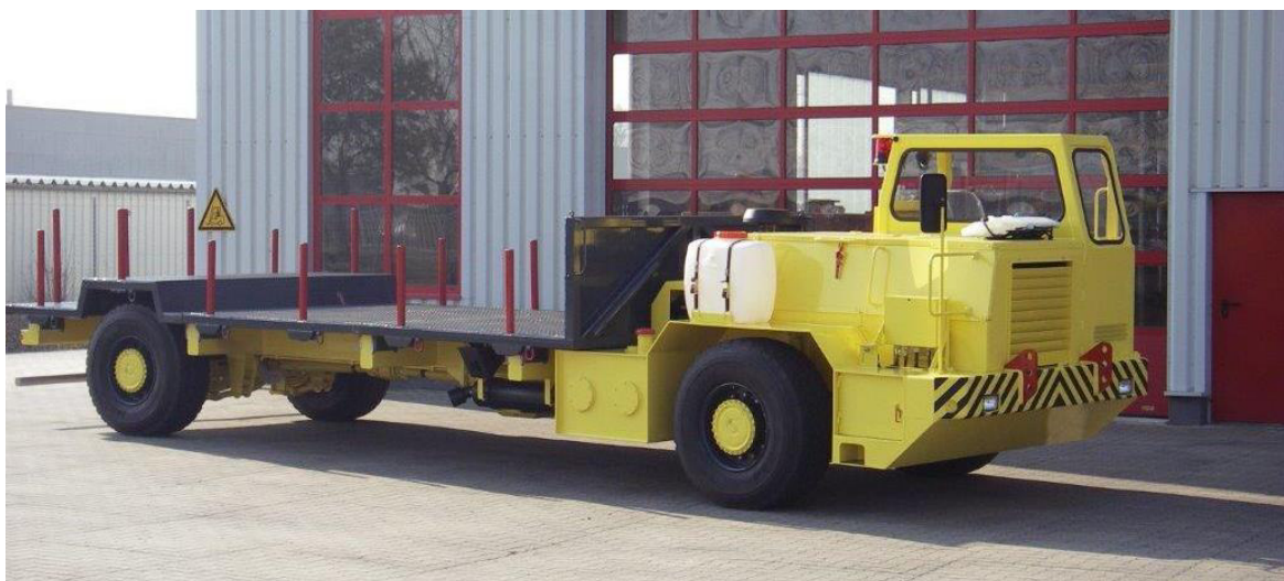
Abbildung 20: Beispielhaftes im untertägigen Bergbau eingesetztes Pritschenfahrzeug
