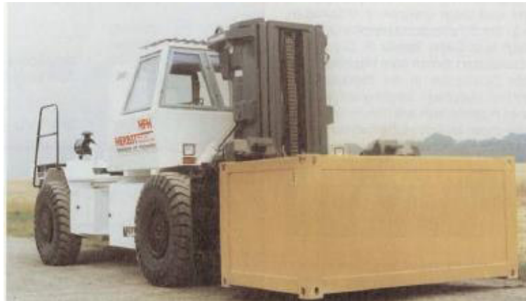
Abbildung 98: Beispielhaftes Stapelfahrzeug für Horizontaltransport von Umverpackungen im Endlager Konrad nach [22]
