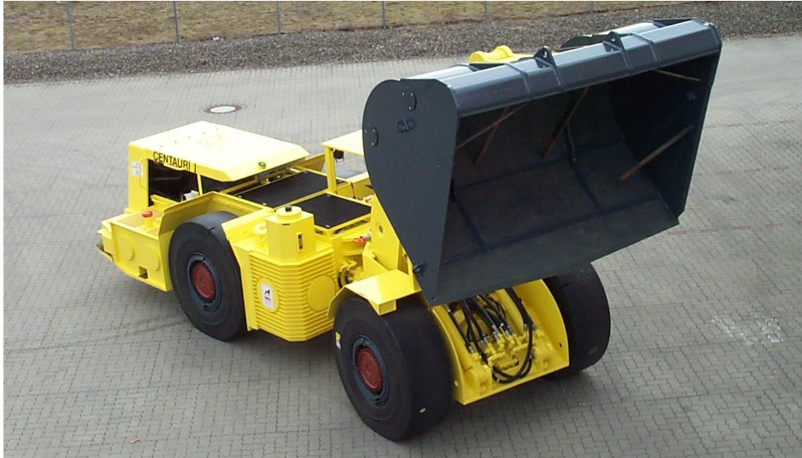
Abbildung 18: Beispielhafter im Bergbau betriebsbewährter Radlader
